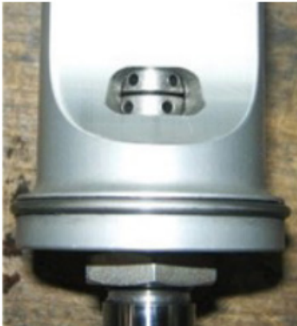
Kuva: Yksiputkivaimennin kahdella säädöllä
