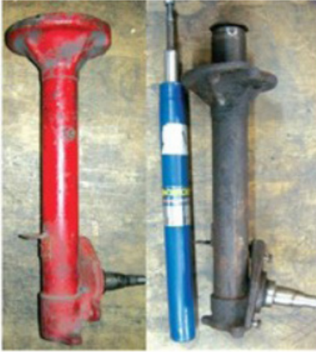
McPherson tolppa, sisäänrakennettu vaimennin (vas.) ja panos (oik.)
