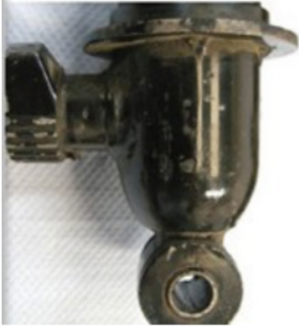
Kuva: Armstrong-vaimennin yhdellä kahteen suuntaan vaikuttavalla säädöllä
